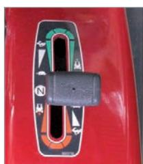
● DOPPIA SELEZIONE VELOCITÀ DI LAVORO O DI TRASFERIMENTO A LEVA E A PEDALE
