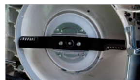
Piatto di taglio dotato di frizione/freno lama BBC.
